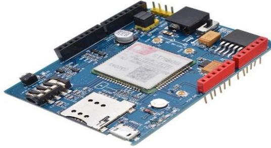
شكل (٢-٥) SIM808 GSM GPS Shield
